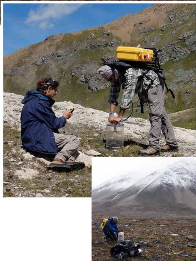
**Fig. 5** - Esempi di misure dei flussi di anidride carbonica e vapor d'acqua fra suolo, vegetazione e atmosfera con l'utilizzo delle camere a flusso portatili nella zona del Gran Paradiso (a sinistra) e alle Svalbard (a destra). Il contenitore a spalla giallo protegge lo spettrofotometro infrarosso (IRGA, *Infrared Gas Analyzer*).
