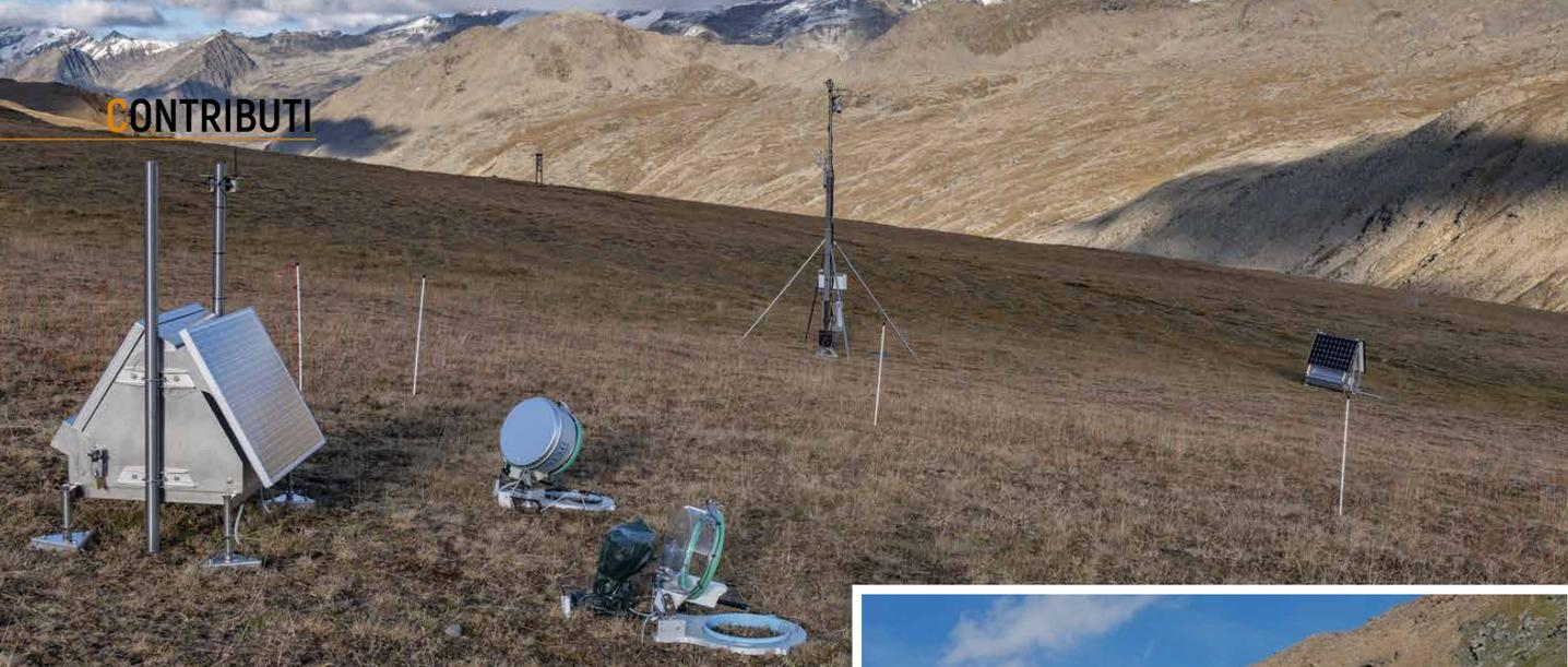
**Fig. 4** - La strumentazione fissa installata all'Altopiano del Nivolet, nel Parco Nazionale Gran Paradiso. In primo piano, una coppia di camere a flusso automatiche con lo spettrofotometro e pannelli solari per la misura di flussi di vapor d'acqua e anidride carbonica. Dietro, la torre di *Eddy Covariance* con i relativi pannelli solari. Sulla sinistra, più distante, il cartello che spiega agli escursionisti il tipo di misure che sono effettuate in questo sito.
