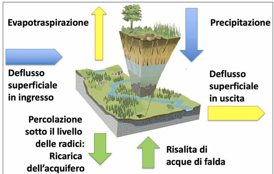
Fig. 8 - Schema semplificato del bilancio idrologico in una porzione della parte superficiale della zona critica. In azzurro gli ingressi di acqua, in giallo le uscite, in verde gli scambi di acqua con la falda freatica. Qui non sono rappresentate né la dinamica dell'acqua nel suolo né la dinamica dell'acquifero.
