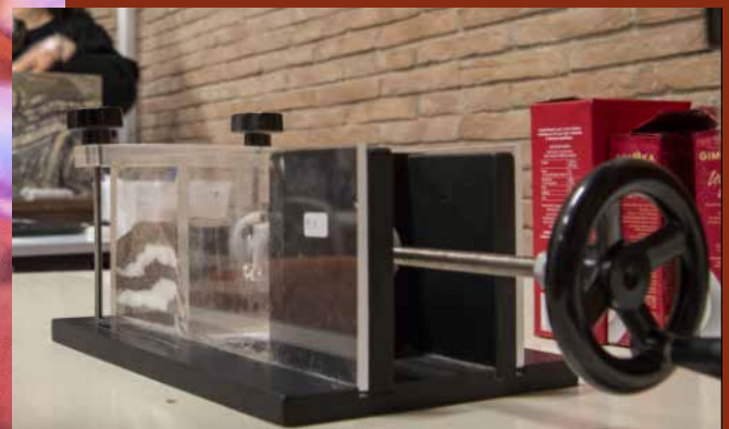
Sand-Box: dispositivo per la simulazione dell'orogenesi di una catena montuosa e per la creazione di strutture come pieghe e faglie.
