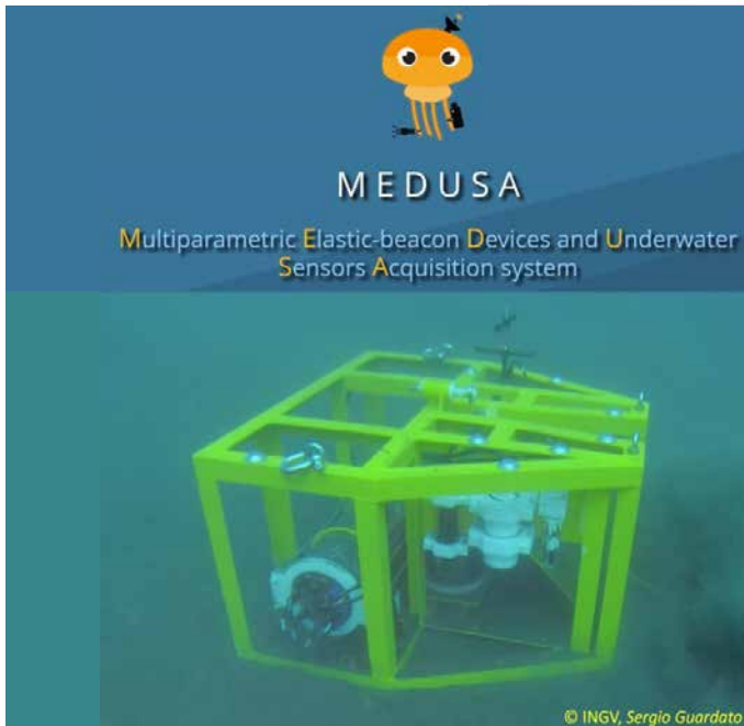
Fig. 5 - Modulo sottomarino di una boa dell'infrastruttura MEDUSA (realizzazione immagine: S. Guardato).
